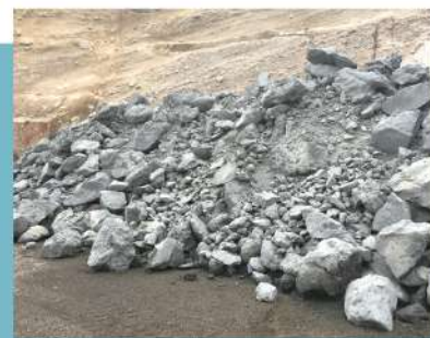
堆積場 ストックヤードより運ばれた混練物を、クラッシャーまで持ち込むまで堆積します。
