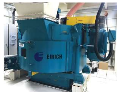
粉体混練ミキサー ドイツのアイリッヒ社製。非常に高い攪拌能力を持つ高速攪拌混合機。
