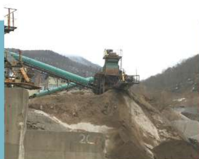
クラッシャー クラッシャーにて破壊・粒度調整し、アッシュロックが完成します。
